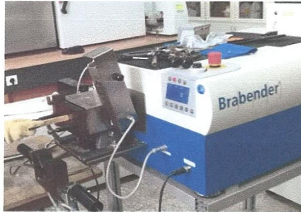
Figure 3.8 – Plastographe de type Brabender [21].
