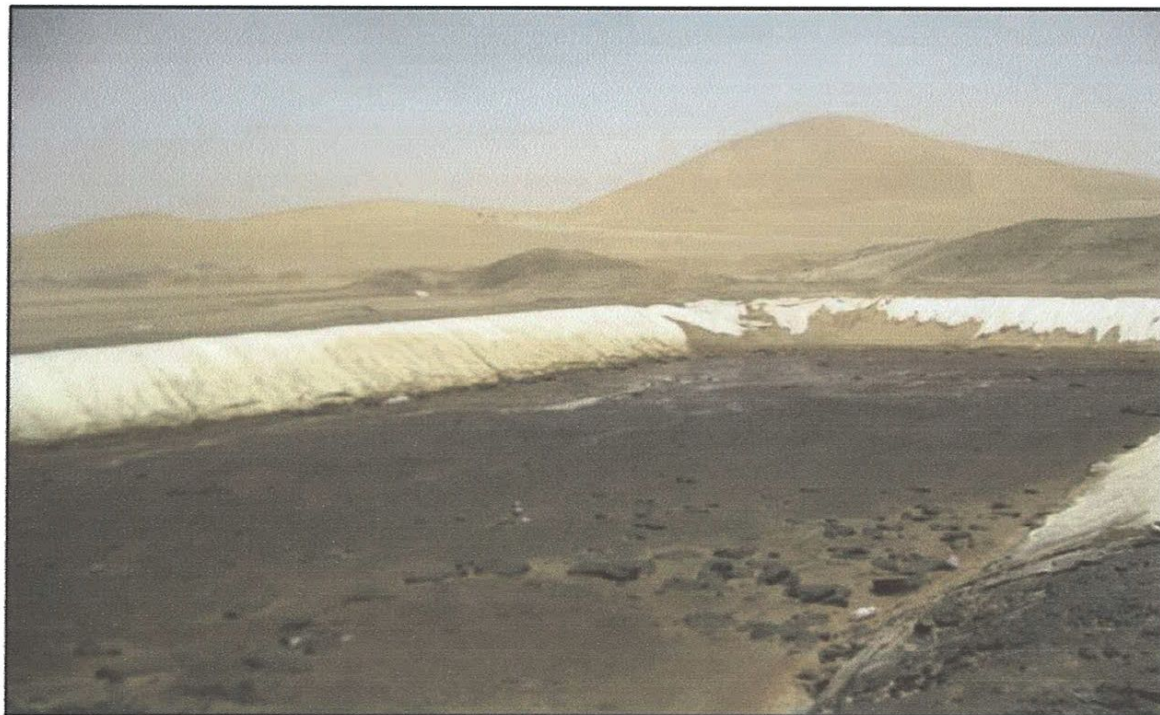
Figure III.2. Bourbier après une opération de forage
