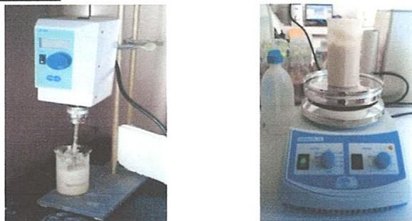
Figure (II.3): Agitateurs de boue, à gauche mécanique, à droite magnétique
