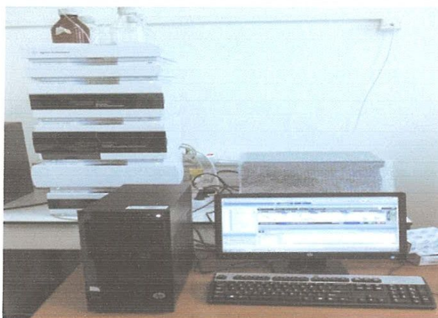
Figure III-2: Appareil pour HPLC (Agilent série 1260 Infinity) utilisé pour le dosage de la catéchine (Laboratoire de Chimie Appliquée, Université de Guelma).
