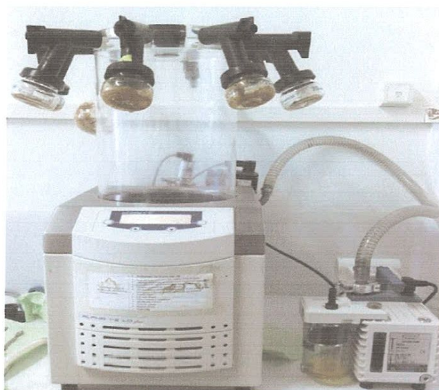
Figure III-1: Lyophilisateur Alpha 1-2 LD plus (Laboratoire de Chimie Appliquée, Université de Guelma).
