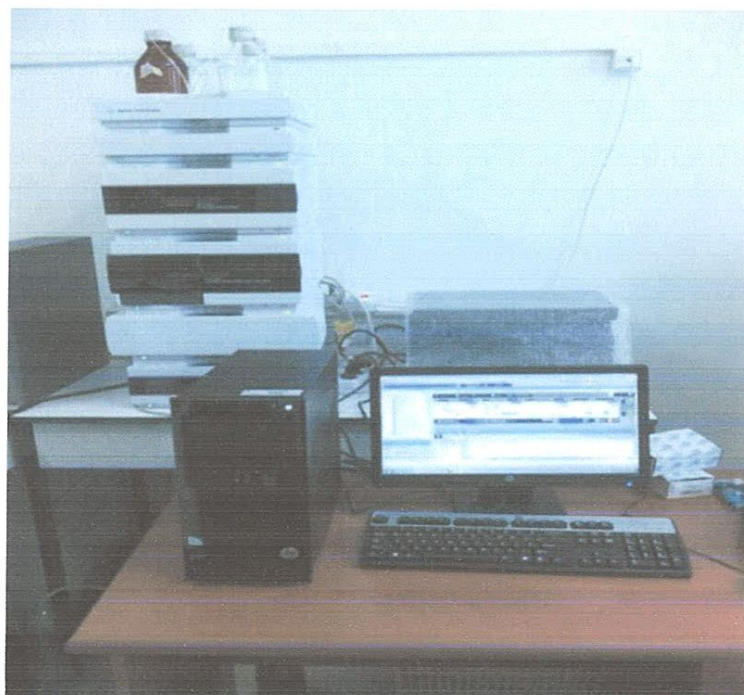
Figure III.2: HPLC (Agilent 1260 Infinity) utilisé dans l'analyse (Laboratoire de Chimie Appliquée, Université de Guelma).
