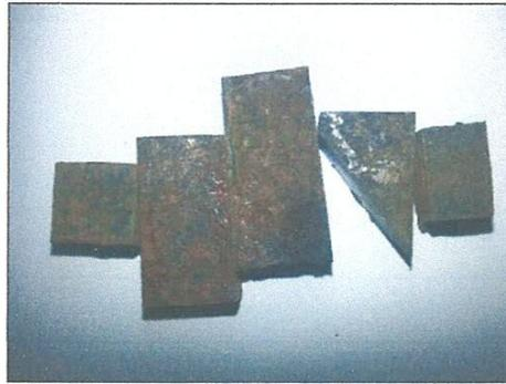
**Figure III.5 :** photo d'échantillon après le découpage est avant le polissage.
