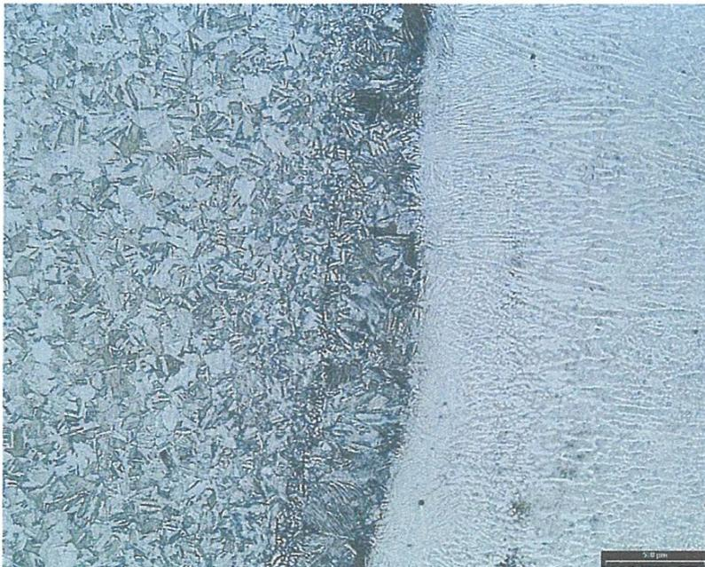
**Figure IV.5:** Détails de l'interface MB et ZAT (Picral).
