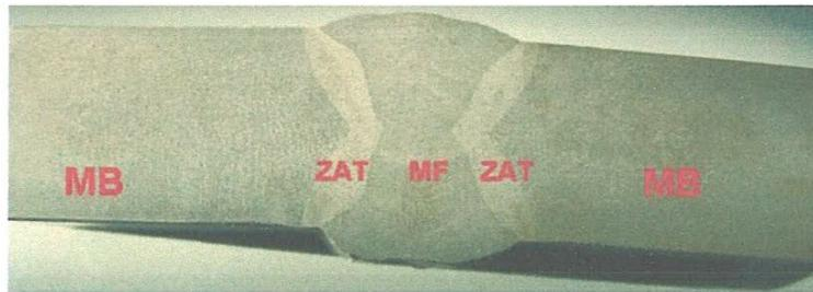
**Figure IV.2 :** Macrographie du joint soudé (Macro-attaque du joint Souder (attaque Nital 10%)).
