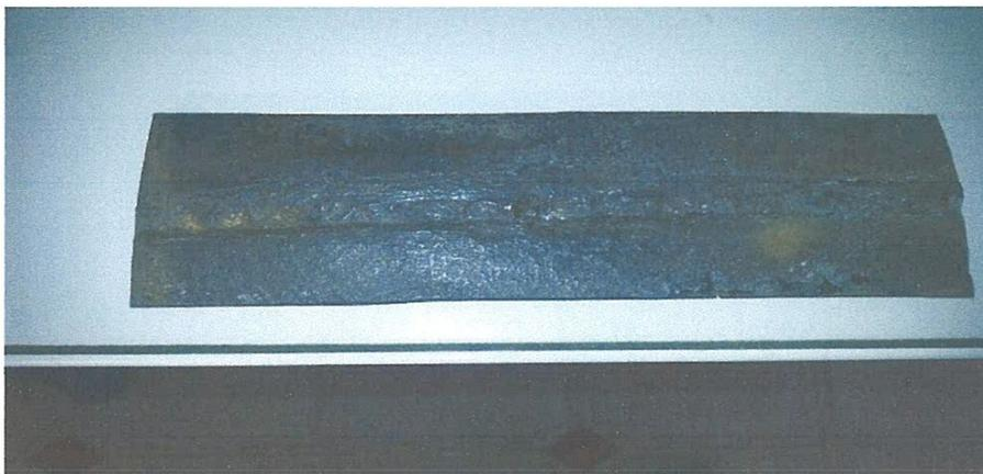
Figure III.1 : photo de la partie de soudure de pipeline attaque par la corrosion bactérienne.
