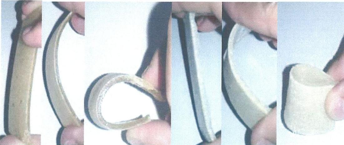
**Figure IV.10 :** Photos des composites PU-sable et PU-CaCO<sub>3</sub>
