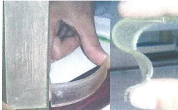
*Figure IV.8 : Aspect des échantillons Polyurethane PU (rigide, semi rigide et souple).*
