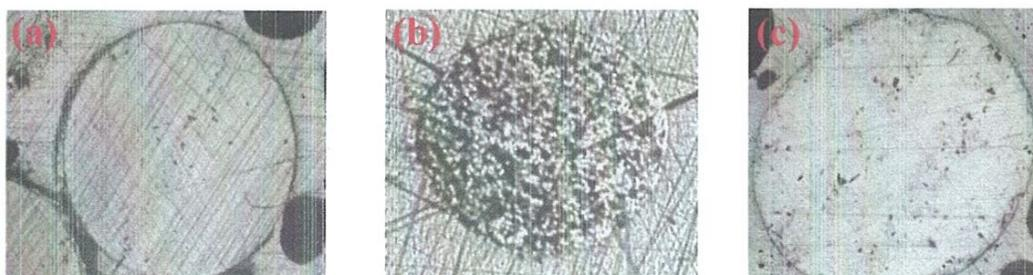
**Figure IV.11 : catalyseur Pt-Re '(a) Neuf, (b) coké, (c) régénéré'**
