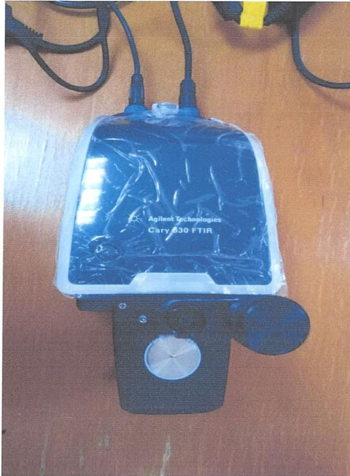
*Figure III.7 : Photo de l'appareil Cary 630 FTIR utilisé dans l'analyse IR.*
