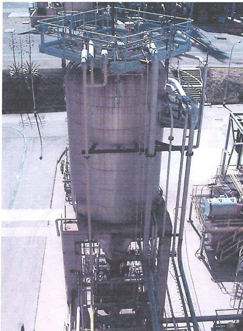
*Figure II.16 : La chambre de flash alternative.*
