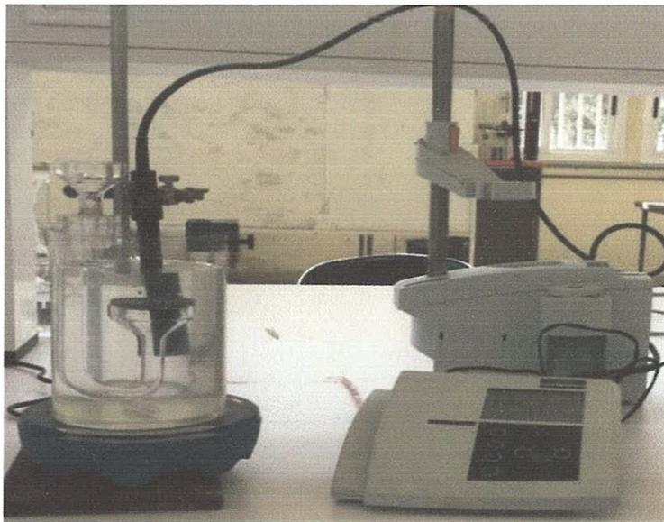
Figure IV.3: Photo de l'appareil de mesure du coefficient de diffusion dans les liquides.
