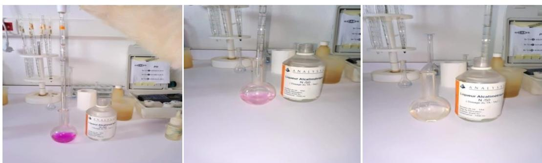
Figure 38 : Détermination du TA de l'eau de chaudière.
