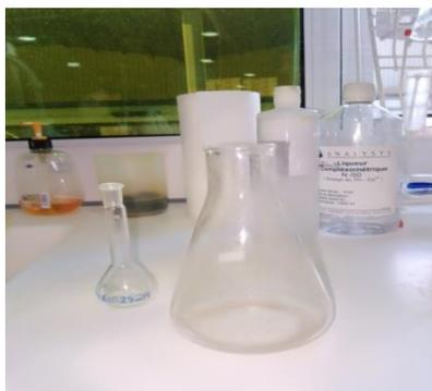
Figure 37 : Détermination du TA de l'eau adoucie.
