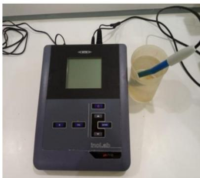
Figure 18 : pH-mètre utilisé au laboratoire.
