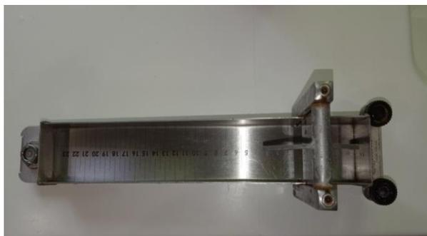
Figure 26 : Consistomètre utilisé au laboratoire.
