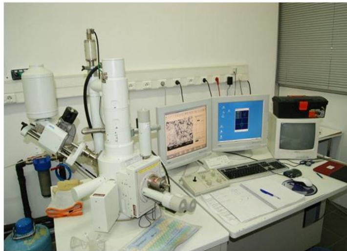
**Figure II.9.** Microscope électronique à balayage.
