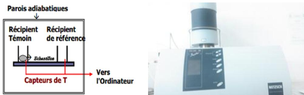
**Figure II.6.** Dispositif de mesure pour la DSC et schéma de principe.
