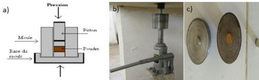
**Figure II.4.** (a) principe de pressage (b) Presse à main (c) Schéma du moule de pressage.
