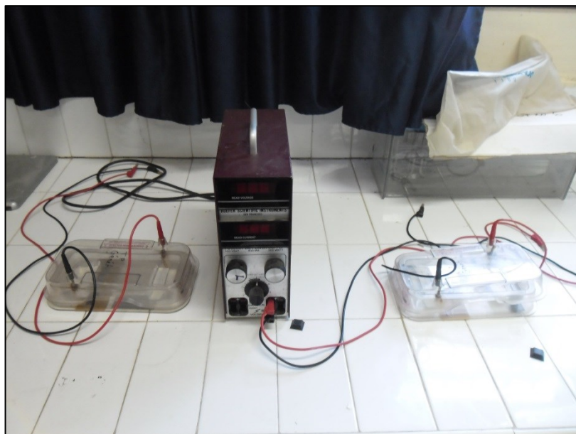
Figure 79 : Le générateur de courant qui assure la migration.
