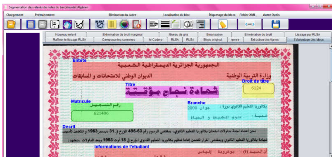
Figure 4.19 : Étiquetage logique des blocs
