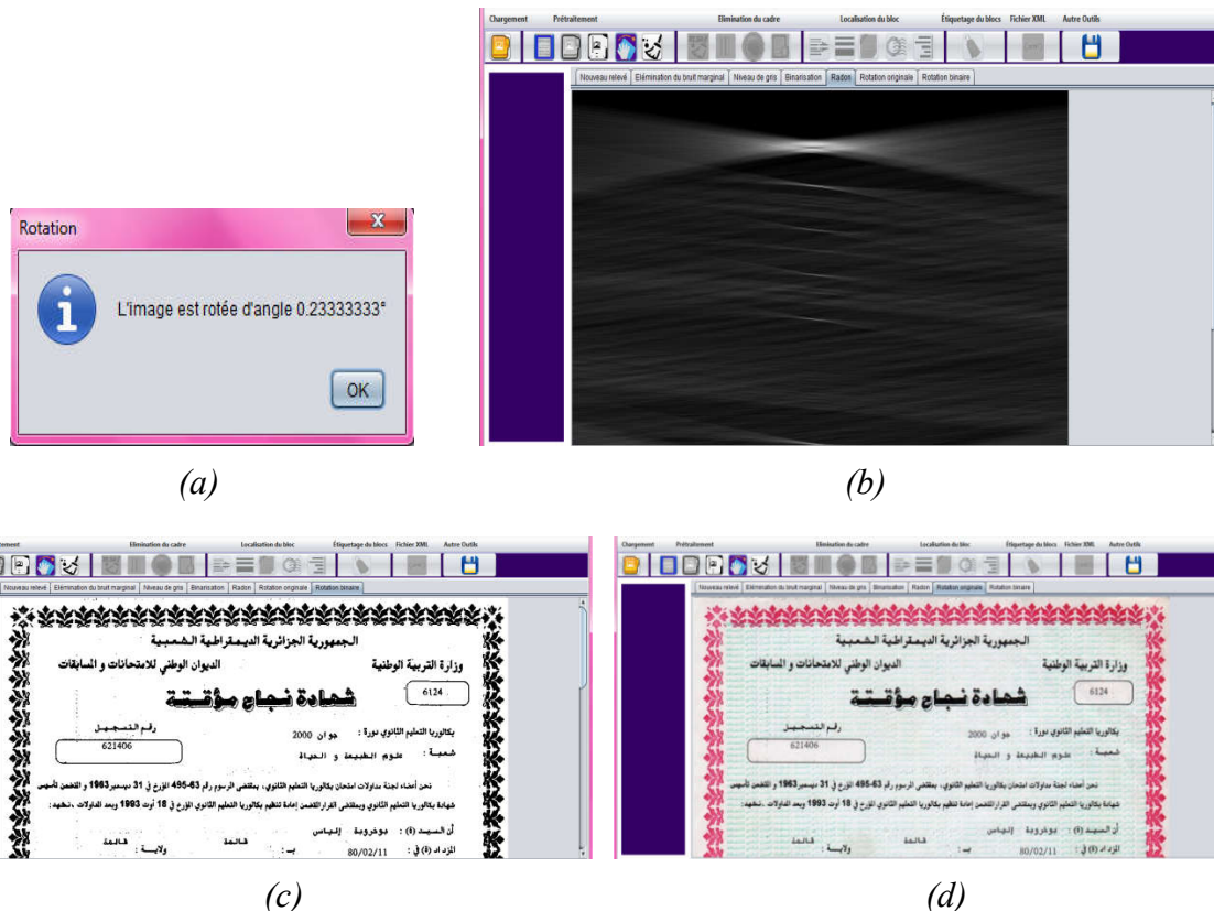
Figure 4.10: Affichage du résultat de la correction de l'inclinaison, (a) message informatif, (b) espace de Radon, (c) Image binaire bien rotée, (d) Image originale bien rotée
