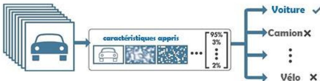
**Figure 2.1** : Un processus de Deep Learning : les images sont transmises à un réseau, qui apprend automatiquement les caractéristiques et classe les objets. [Web07]
