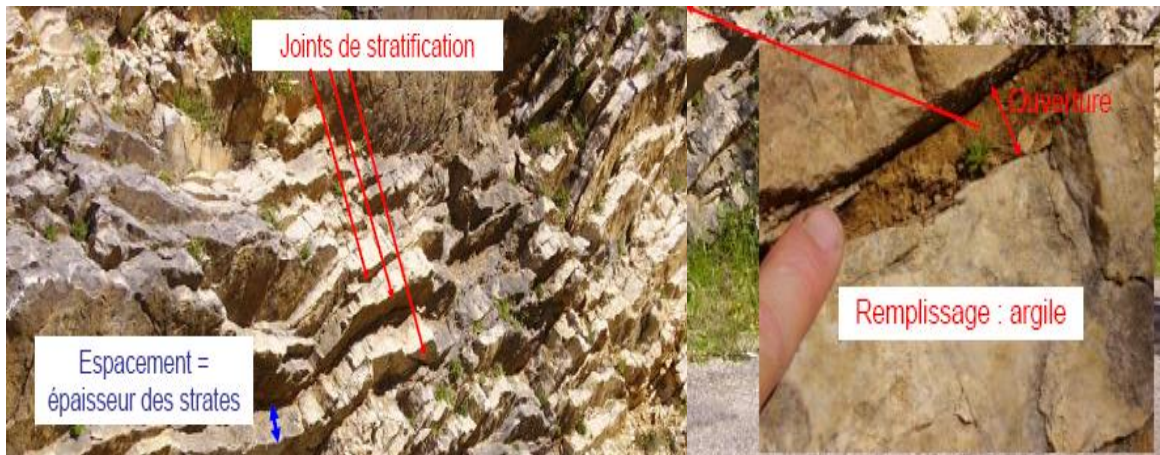
Fig. I.13 Espacement, ouverture et remplissage des joints. [17]
