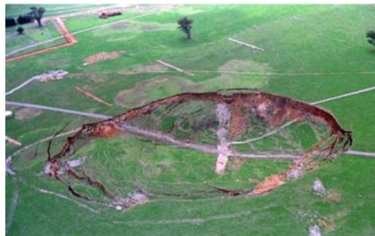
Figure 28 : Photo d'un affaissement de sol
