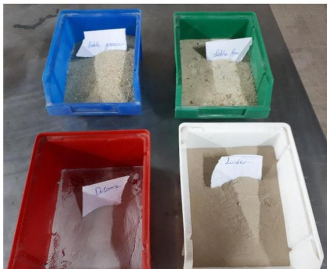
Figure 83 : Photo des constituants de notre mortier
