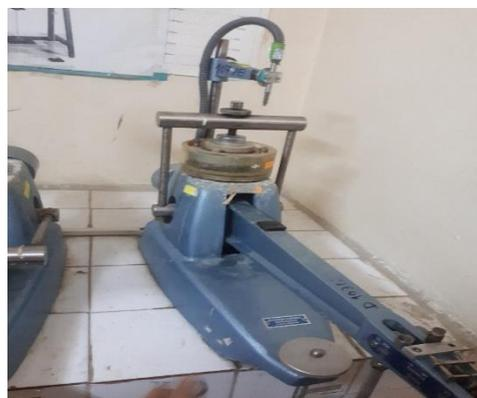
Figure 87: Appareillage de l'essai de gonflement à l'œdomètres
