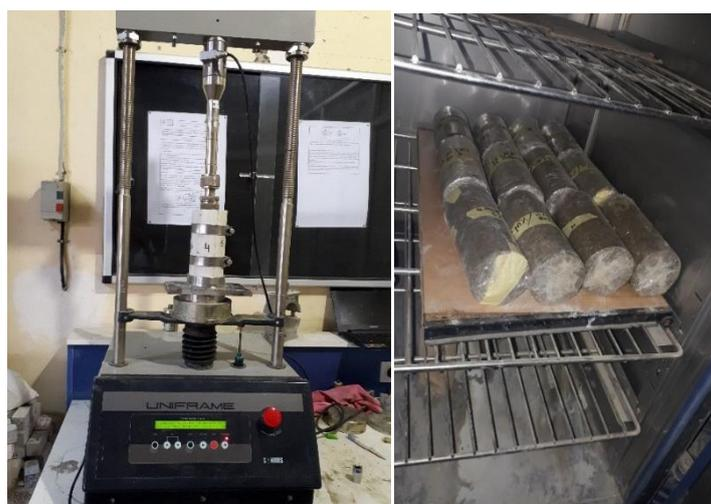
Figure 68 : Photos la machine de compactage UNIFRAME et de la chambre climatique
