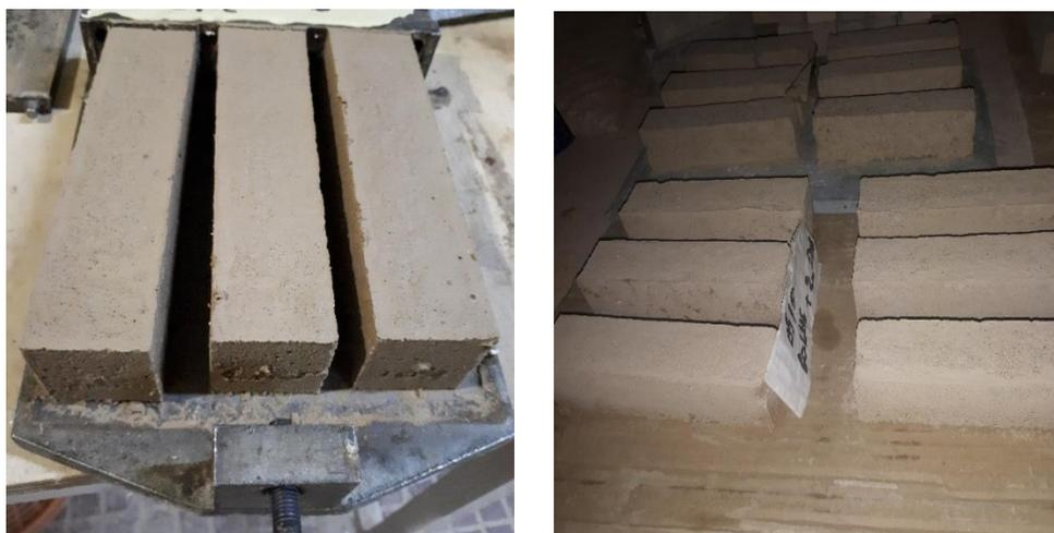
Figure 85: Photos de démoulage des éprouvettes de notre mortier
