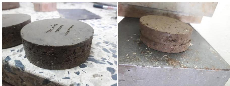
Figure 93: Photo de notre sol avant et après l'essai de cisaillement
