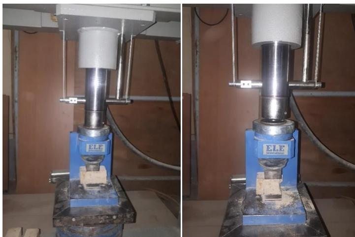
Figure 86: Photos de l'essai de compression pendant et après la rupture
