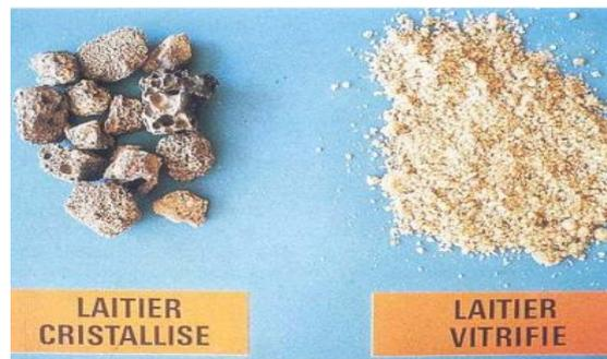
Figure 29 : laitier cristallisé et laitier vitrifié granulé de haut fourneau
