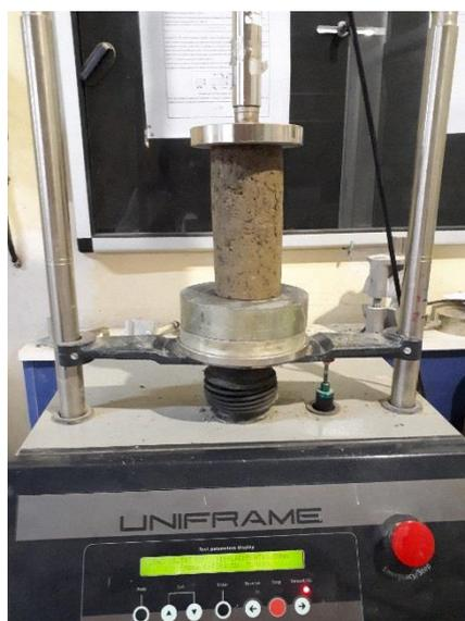
Figure 69: Photo de l'essai de résistance à la compression simple
