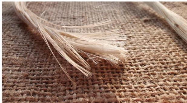
Figure 51: Fibre de jute et toile de jute
