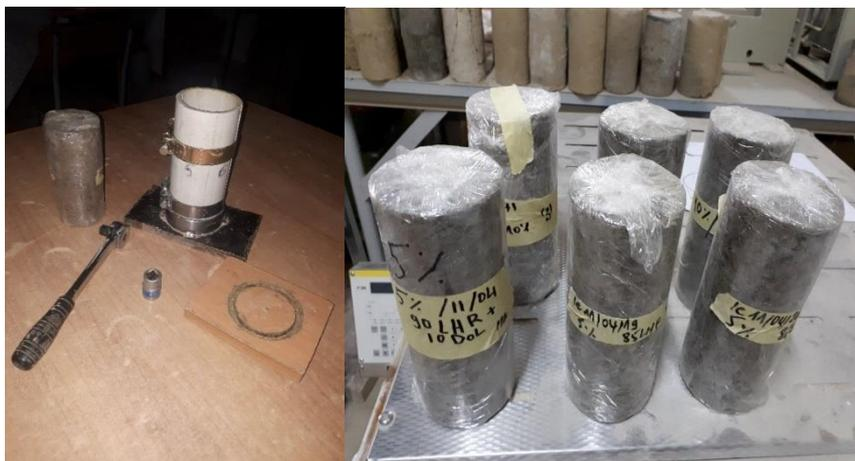
Figure 67 : Photos du moule et de quelques éprouvettes confectionnées
