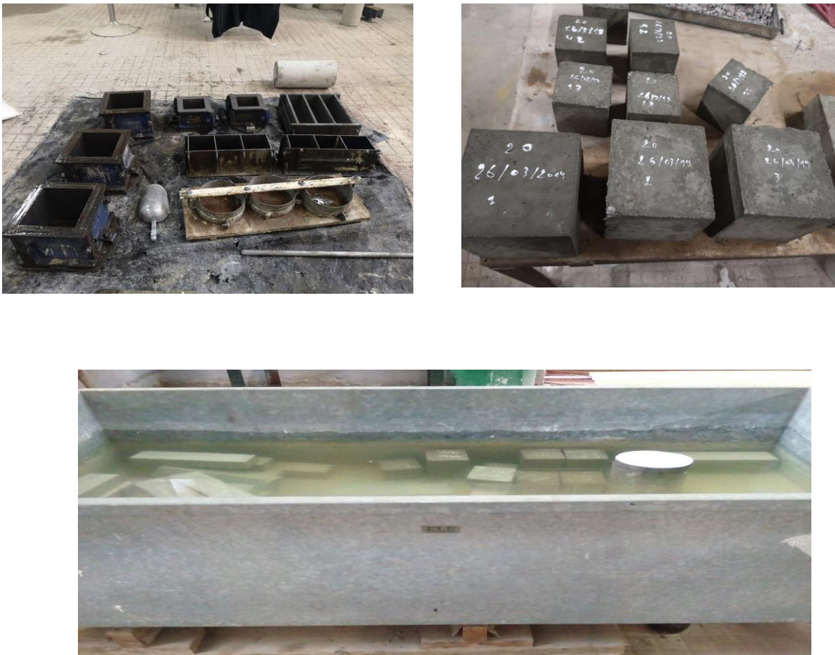
Figure II.10 : La mise en place du béton et la conservation des éprouvettes avant le démoulage
