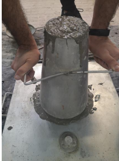
FigureII.11 : l'essai de mesure de consistance du béton frais
