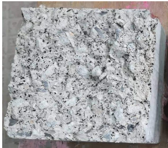
Figure III.3 : distribution des particules de caoutchouc dans une éprouvette BC40% écrasé par fendage.
