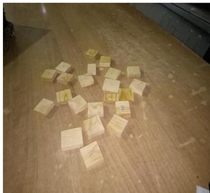
Figure 2.12: Epreuves pour la mesure de la densité et teneur en eau.
