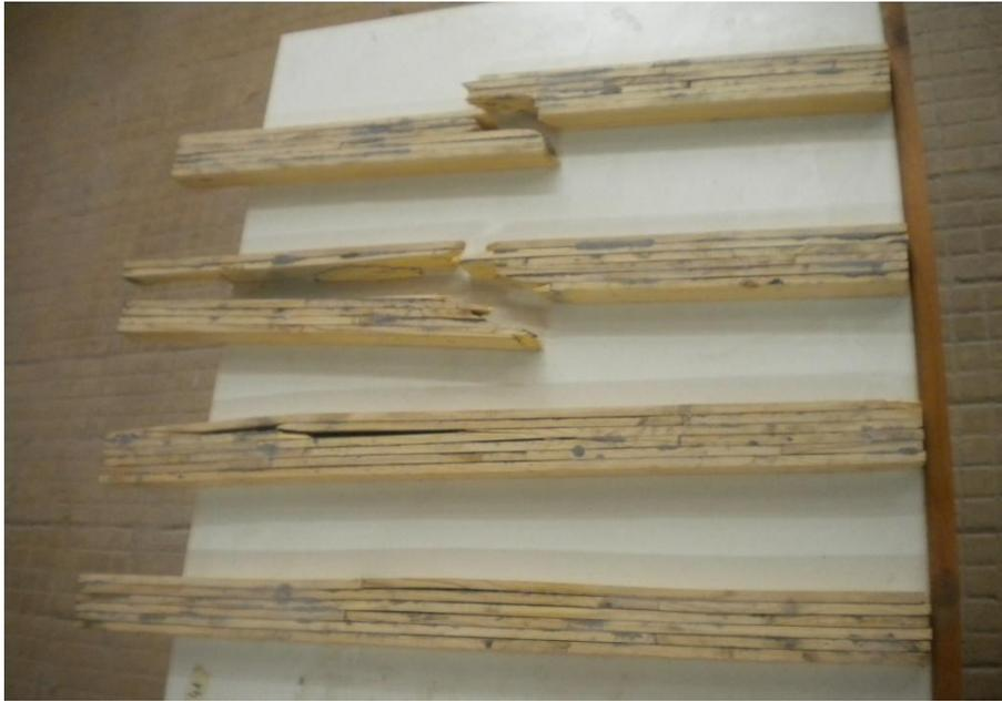
Figure 3.7 : Les ruptures sur les poutres lamellée-collées.
