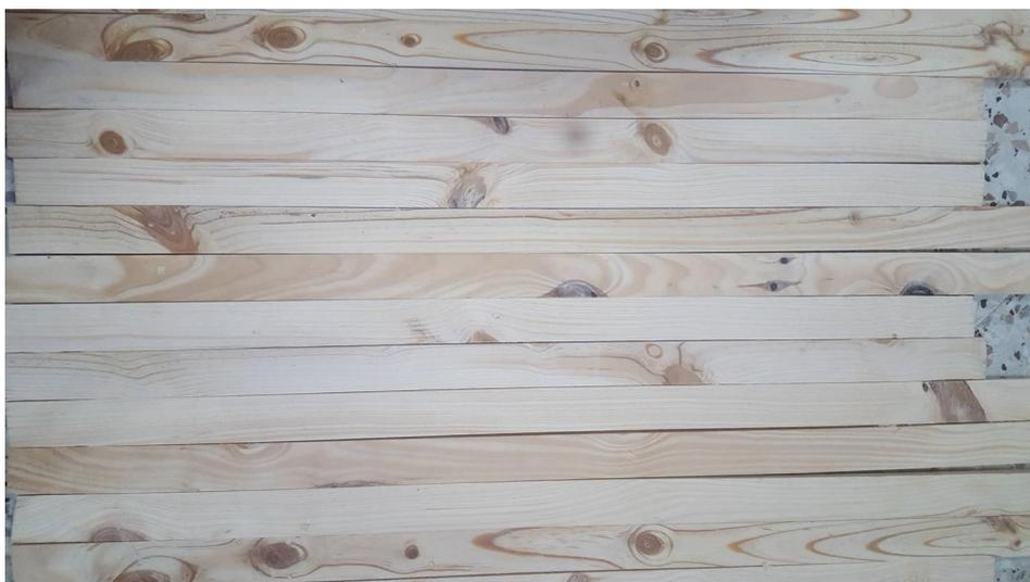
Figure 2.3 : Les lamellés de bois avec défauts.
