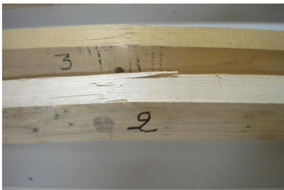
Figure 3.6 : Mode de rupture de 2<sup>ème</sup> et 3<sup>ème</sup> poutre de bois de coffrage.
