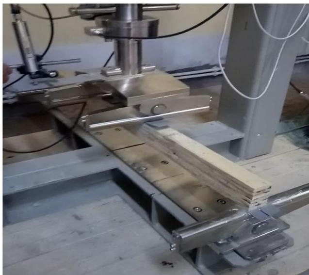
Figure 2.19 : Poutre lamellée collée.
