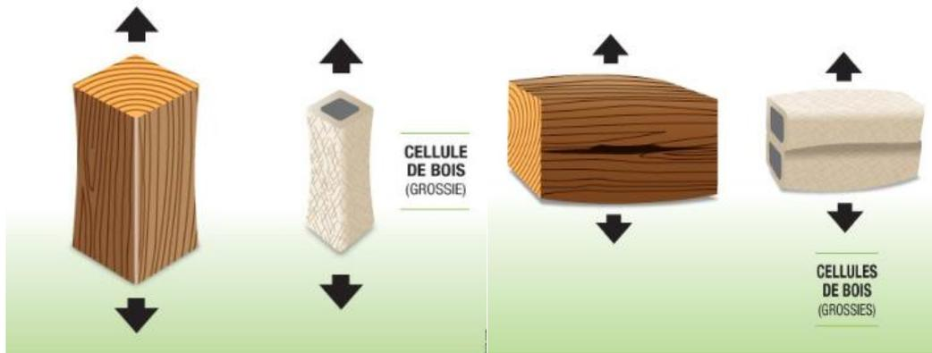
Figure 1.4 : Traction parallèle et perpendiculaire au fil.
