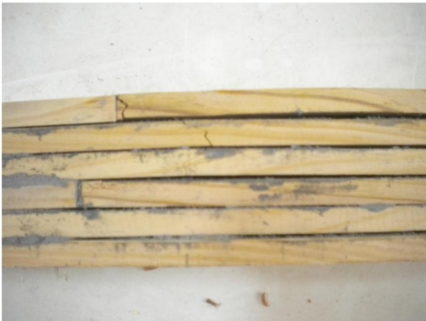
Figure 3.8 : mode de rupture de la troisième poutre.
