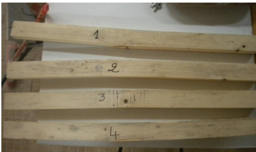
Figure 3.5 : les ruptures sur les poutres de bois de coffrage.
