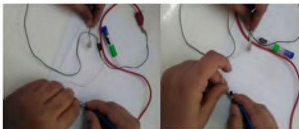
Figure III.11: Tests de conductivité du composite OG-PANI avec FeCl_3 et avec (NH_4)_2S_2O_8 .
