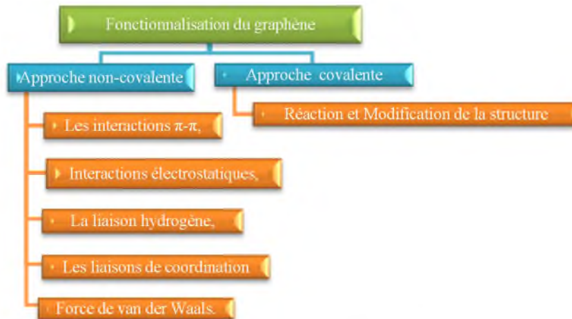
Figure I.24: la fonctionnalisation covalente et non covalente du graphène.
