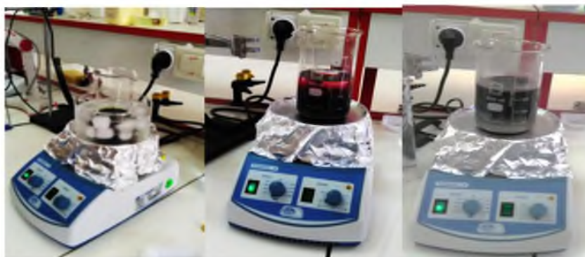
Figure III.3: Suivre la production de l'OG par exfoliation chimique (méthode d'Hummers).
