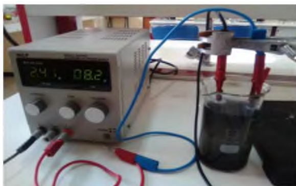
Figure II.1: Montage de synthèse de l'OGr par exfoliation électrochimique.
