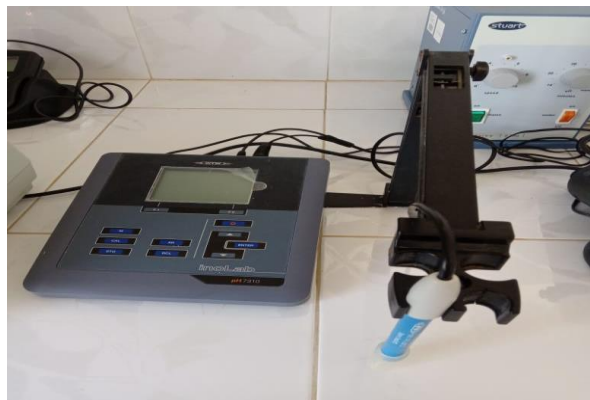
Figure IV. 3. Image d'un pH-mètre utilisé lors des analyses.
