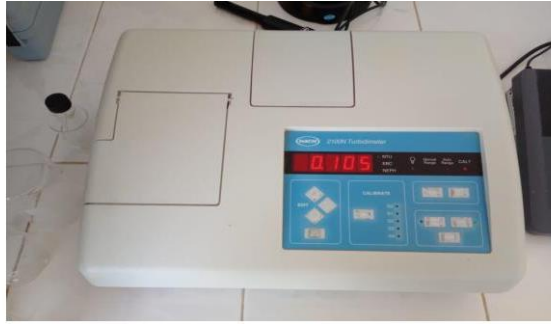
Figure IV. 5. Image d'un turbidimètre utilisé lors des analyses.
