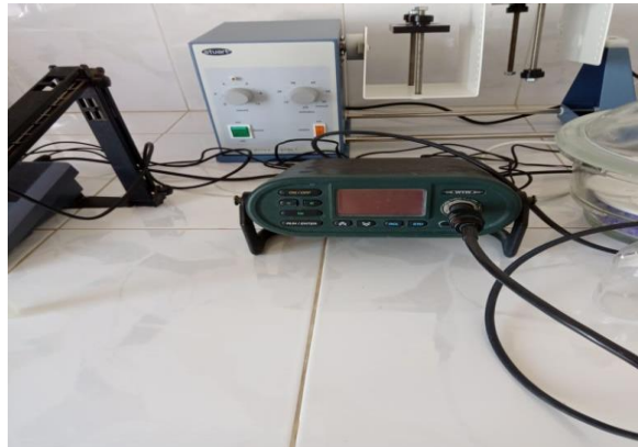
Figure IV. 4. Image d'un conductimètre utilisé lors des analyses.
