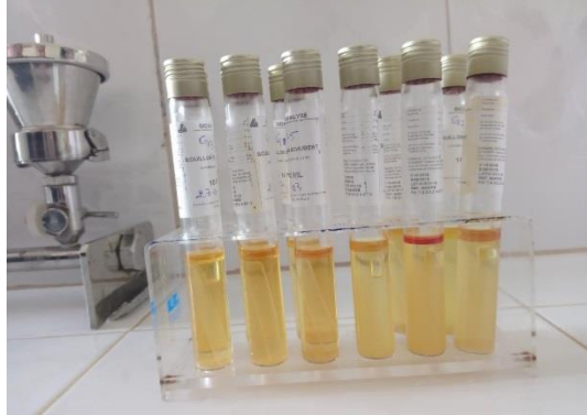
Figure IV. 11. Image représente les résultats des coliformes totaux et fécaux.
