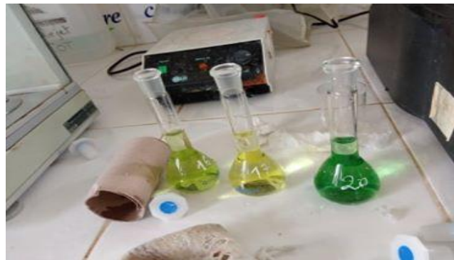
Figure IV.9. Image représente l'analyse le dosage d'ammonium.
