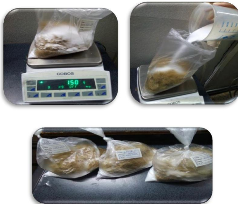
Figure II.8 : Différents pourcentages de fibres de lin dans le PEHD.
