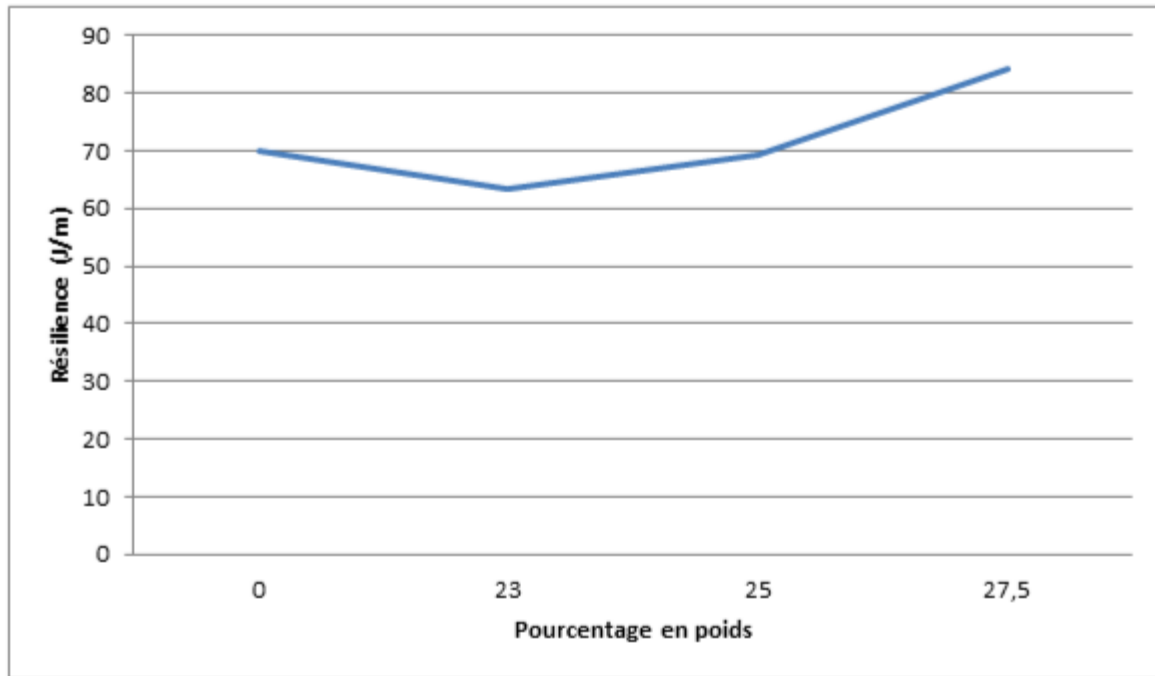
Figure III.4 : Variation de la résilience Izod en fonction des pourcentages de PEHD-FL-M.
