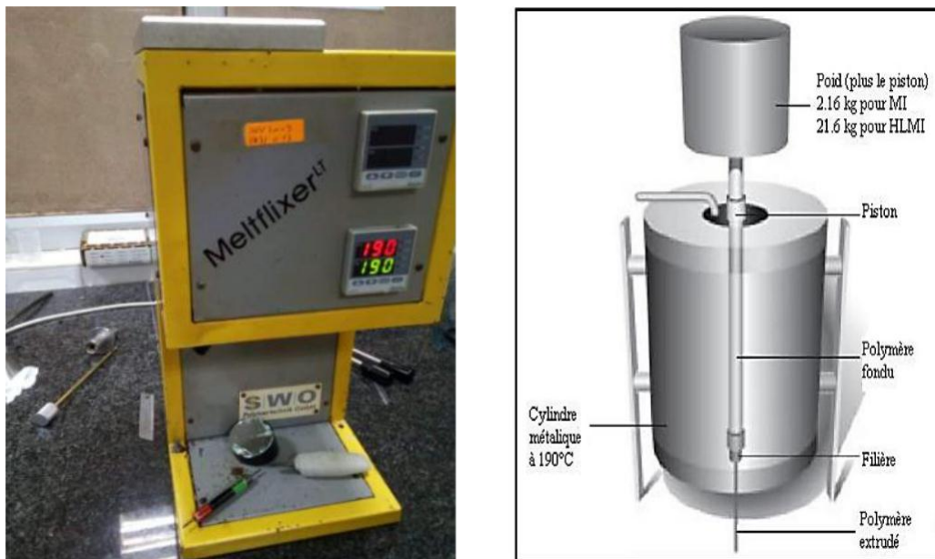
Figure II.16 : Appareillage de mesure du Melt Flow Index. [44]
