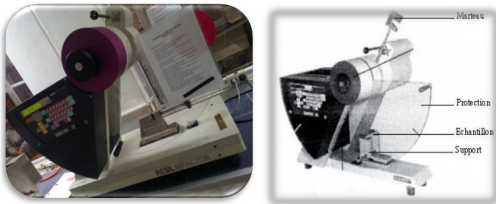
Figure II.12 : Appareillage pour le calcul de la résilience selon l'essai IZOD [44].
