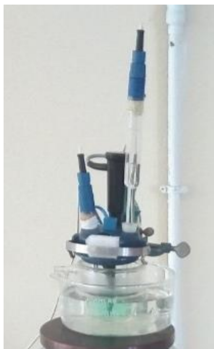
Figure III. 3 : Cellule électrochimique utilisée pour l'élaboration des couches de Ni.
