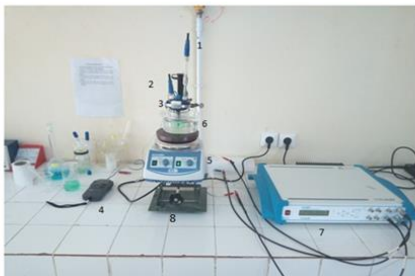
Figure III.2. Photographie du montage utilisé pour l'électrodéposition du nickel.
