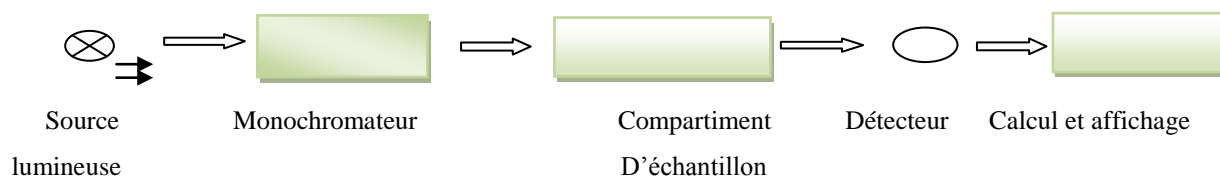
Figure III-1 : Schéma descriptif de fonctionnement d'un spectrophotomètre UV-Visible.
