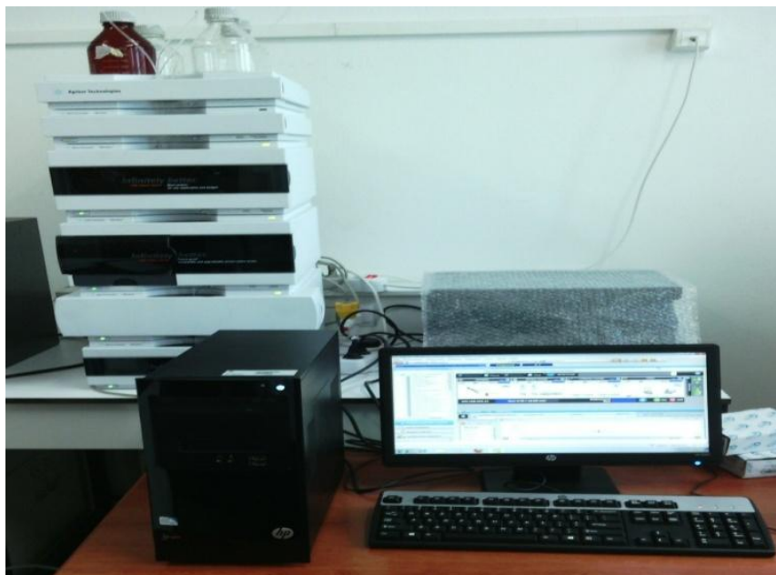
Figure-2 : Appareil pour HPLC (Agilent série 1260 Infinity) utilisé pour le dosage de la catéchine (Laboratoire de Chimie Appliquée, Université de Guelma).
