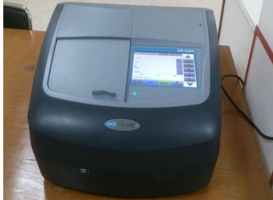
**Figure III.7 :** Spectrophotométrie UV visible (HACH LANGE).
