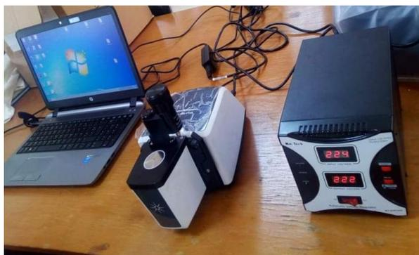
**Figure III.6 :** Spectrophotomètre Infrarouge (Argilent Cary 630 FTIR).
