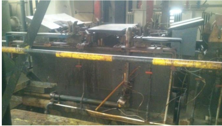
Figure I.16 : Bain de chromage dur dans l'usine de GERMAN
