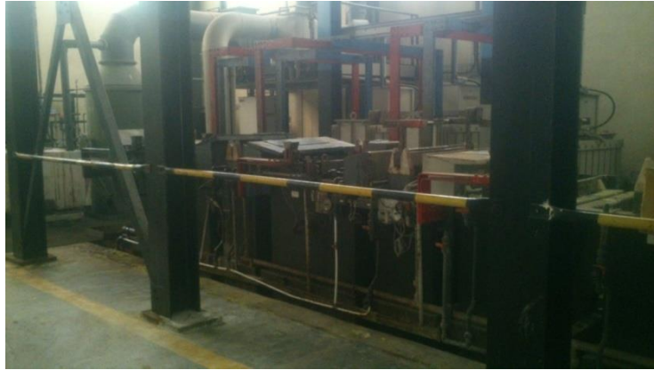
Figure I.22 : Chaîne de bains dans l'atelier de chromage de GERMAN
