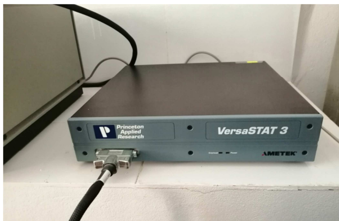
Photo III.1 POTENTIOSTAT (AMETEK, USA) utilisé dans ce travail
