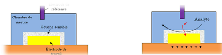
Figure I.4 Principe de la transduction par ampérométrie[13]
