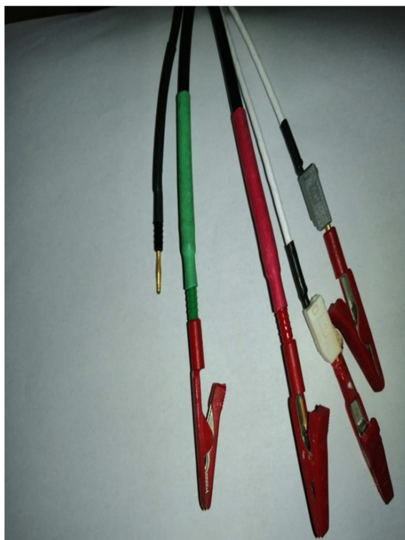
Photo III.6 Fils de connexion électrique
