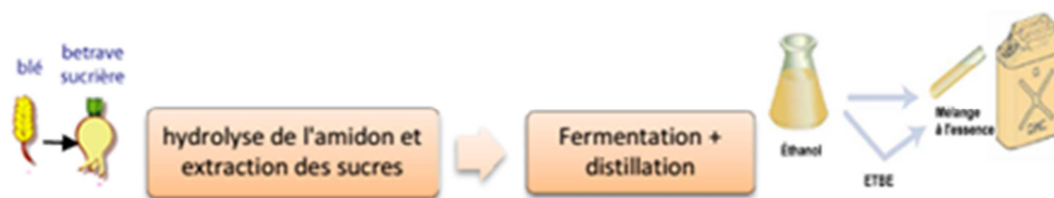
Figure II.3 Schémas de production de biocarburant [6]
