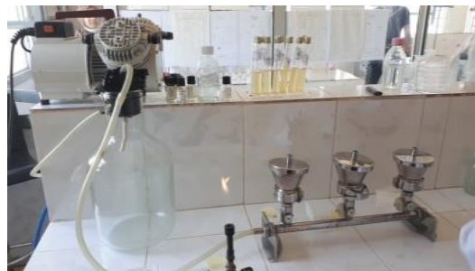
Photo 6 : La rampe de la filtration.
