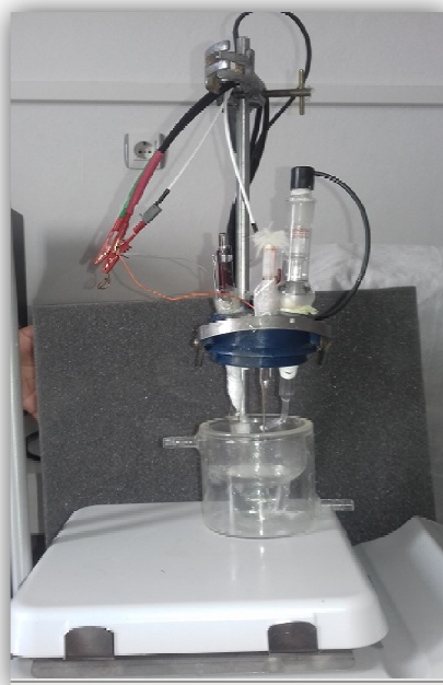
Figure III.6 : Montage expérimentale utilisé pour l'activation des dépôts
