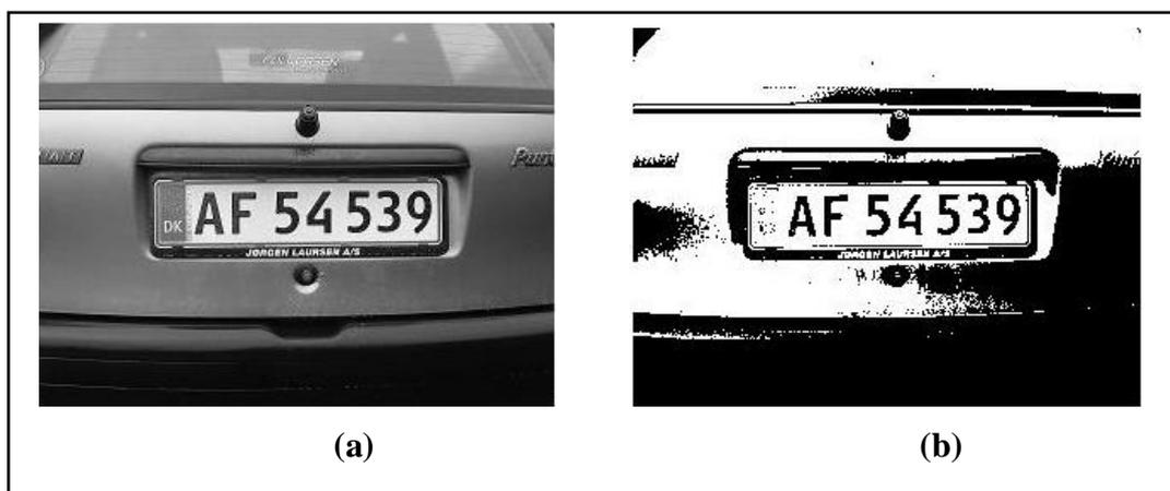
**Figure II.31** : Conversion en image binaire, (a) : Image en niveau de gris, (b) : Image binarisée
