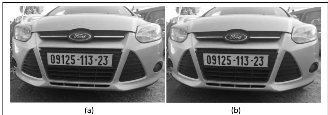
**Figure III.5** : Filtrage d'image, (a) : Image en niveau de gris, (b) : Image filtrée
