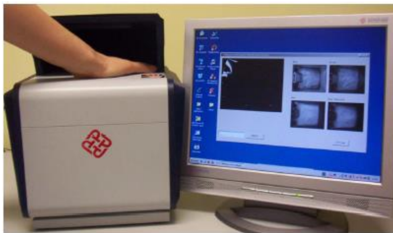
Figure 2.8 : Structure externe d'un dispositif d'acquisition d'image palmaire multi spectrale [28]
