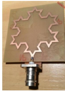
Figure I.1: Antenne imprimée à fractales de Koch d'ordre 3 [I.4].
