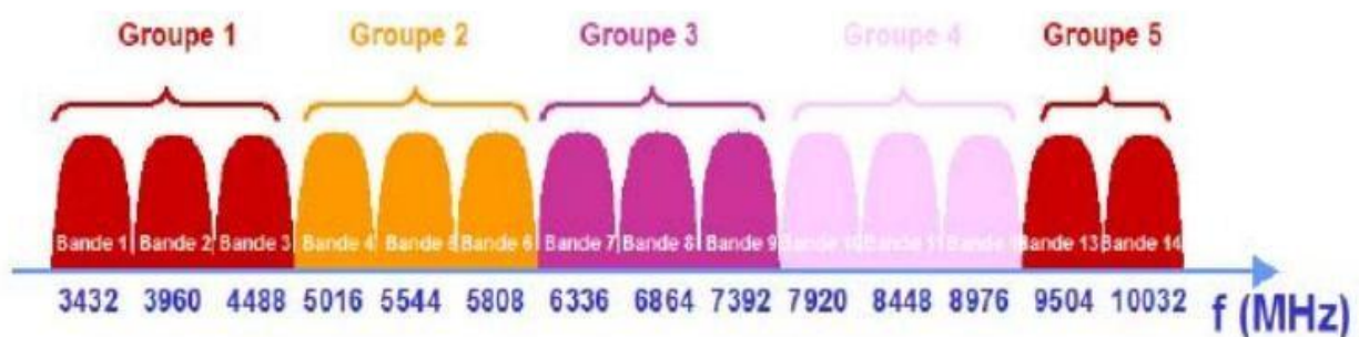
Figure II.7 : Principe de la base des systèmes ULB multi-bande.
