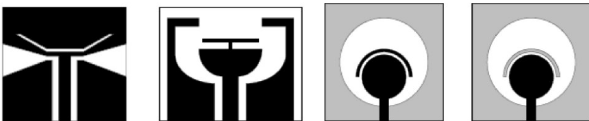
Figure II.27 : Antennes UWB à fréquence rejetée par utilisation de fentes à proximité de l'élément rayonnant.
