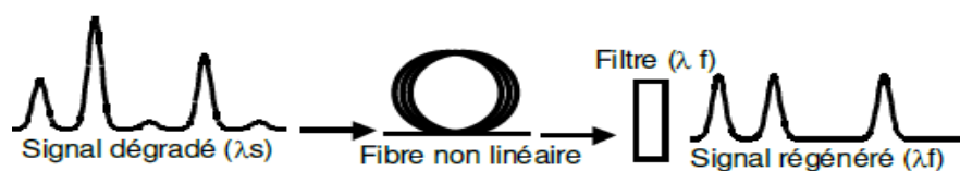
Figure II.8: Schéma d'un régénérateur 2R à base sur l'automodulation de la phase dans les fibres.
