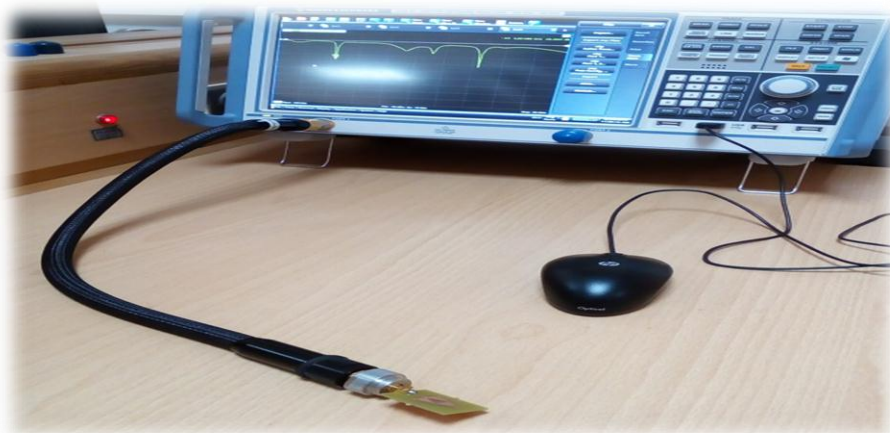
Figure III.23 Analyseur de réseau vectoriel
