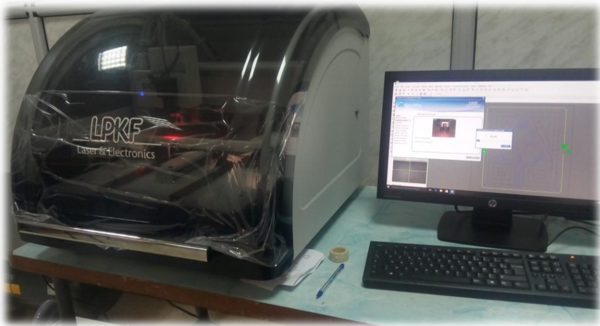
Figure III.21 La machine à gravure LPKF Protomat S103
