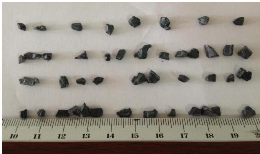
**Figure III.5 :** Aspect et dimension des granules d'Acrylonitrile Butadiène Styrène(ABS)
