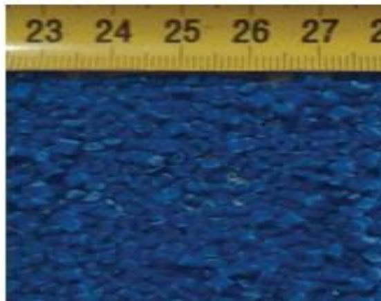
**Figure III.11:** Echantillon des granules de polyamide (PA) utilisés
