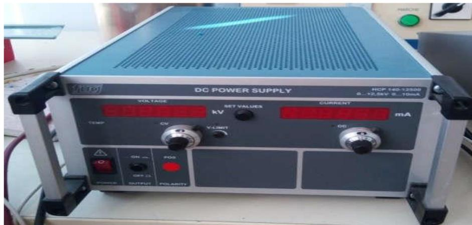
**Figure III.3 :** Photographie de générateur de haute tension positive (+) utilisé
