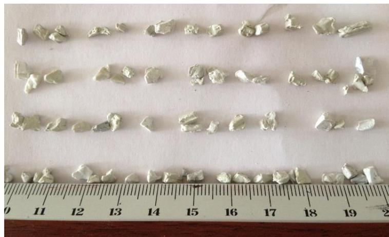
Figure II.6: Aspect et dimension des granules de polystyrène à fort impact (HIPS)
