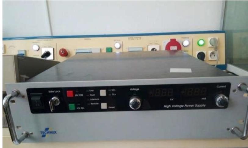
**Figure III.2 :** Photographie de générateur de haute tension négative (-) utilisé
