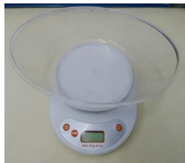
Figure II.11: Balance électronique (5 kg/1g)
