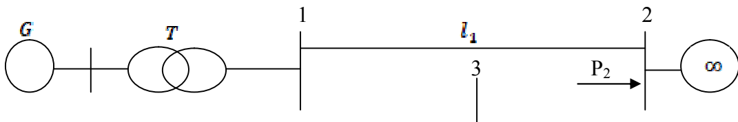
Figure. IV.6 : Schéma équivalent du réseau de transport après élimination de la ligne en court-circuit.
