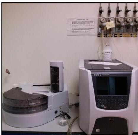
Figure 10. Appareil de mesure du carbone organique total (COT).
