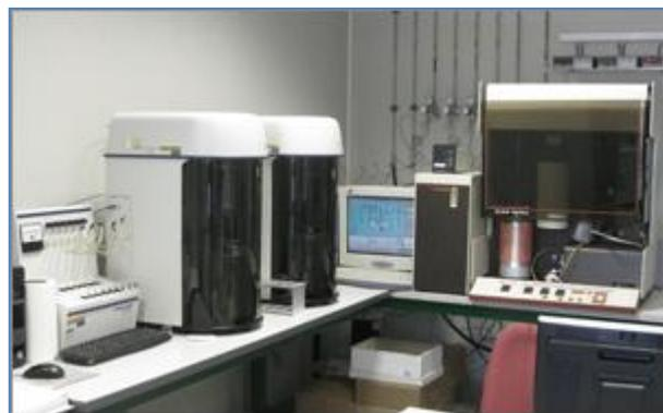
Figure 8. Instrument de mesure de la surface spécifique par B.E.T.
