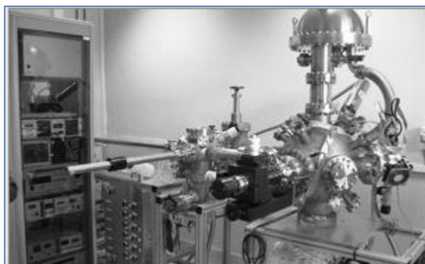
Figure 7. Instrument de la spectroscopie photoélectronique à rayons X (XPS).
