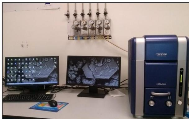
Figure 6. Microscopie électronique à balayage (SEM-EDX).
