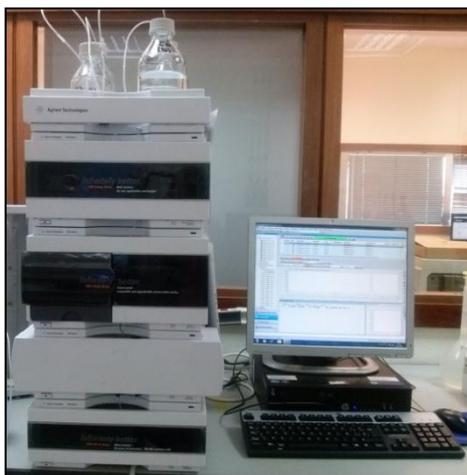
Figure 9. Chromatographie liquide haute résolution (HPLC-UV).
