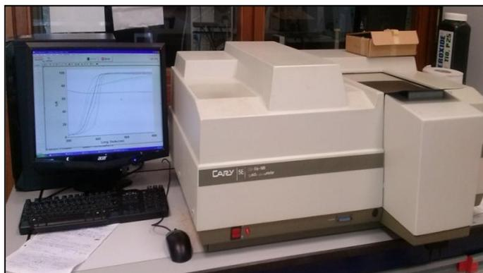
Figure 4. Spectrophotométrie en réflectance diffuse (UV-vis DRS).
