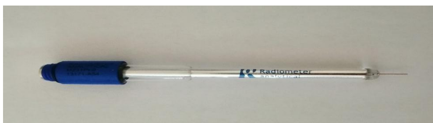
Figure II.2: Electrode de platine utilisé, de marque Radiometer analytical , type: M231Pt-9
