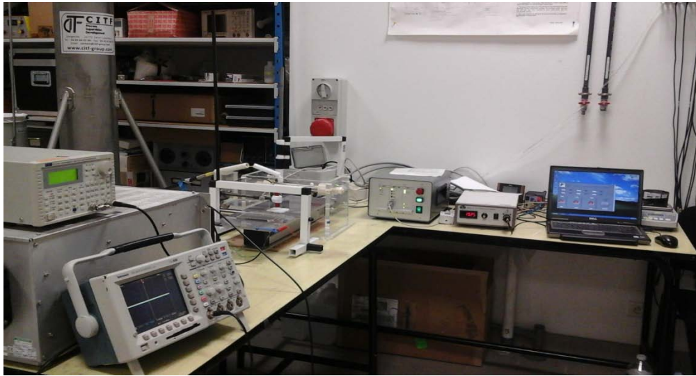
Figure II.11 : Installation expérimentale utilisée pour l'étude de la neutralisation des granules par décharge à barrière diélectrique.
