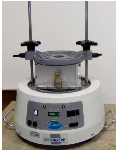
Figure II.12 : Photographie du système de charge par effet triboélectrique.
