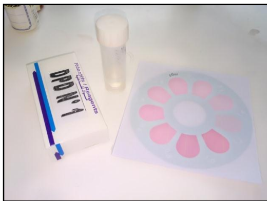
Figure 34 : Dosage de chlore libre de l'eau avant et après traitement (photo prise par DAFRI, 2019).
