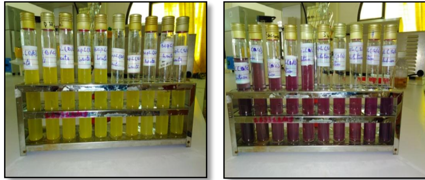
Figure 50 : Photo montre les résultats de la recherche des coliformes totaux (colimétrie) dans l’eau avant et après traitement (photo prise par KHAMASSI, 2019).
