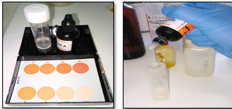
Figure 35 : Dosage de fer de l'eau avant et après traitement (photo prise par DAFRI, 2019).
