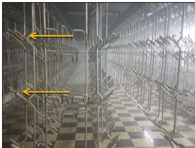
Figure 31 : Image montre l'accumulation de la graisse sur les crochets [Source : photos personnelle]
