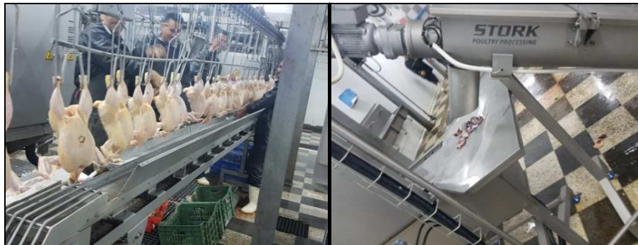
Figure 24: Images de l'éviscération manuelle et le nettoyage des gésiers par une machine spécialisée
