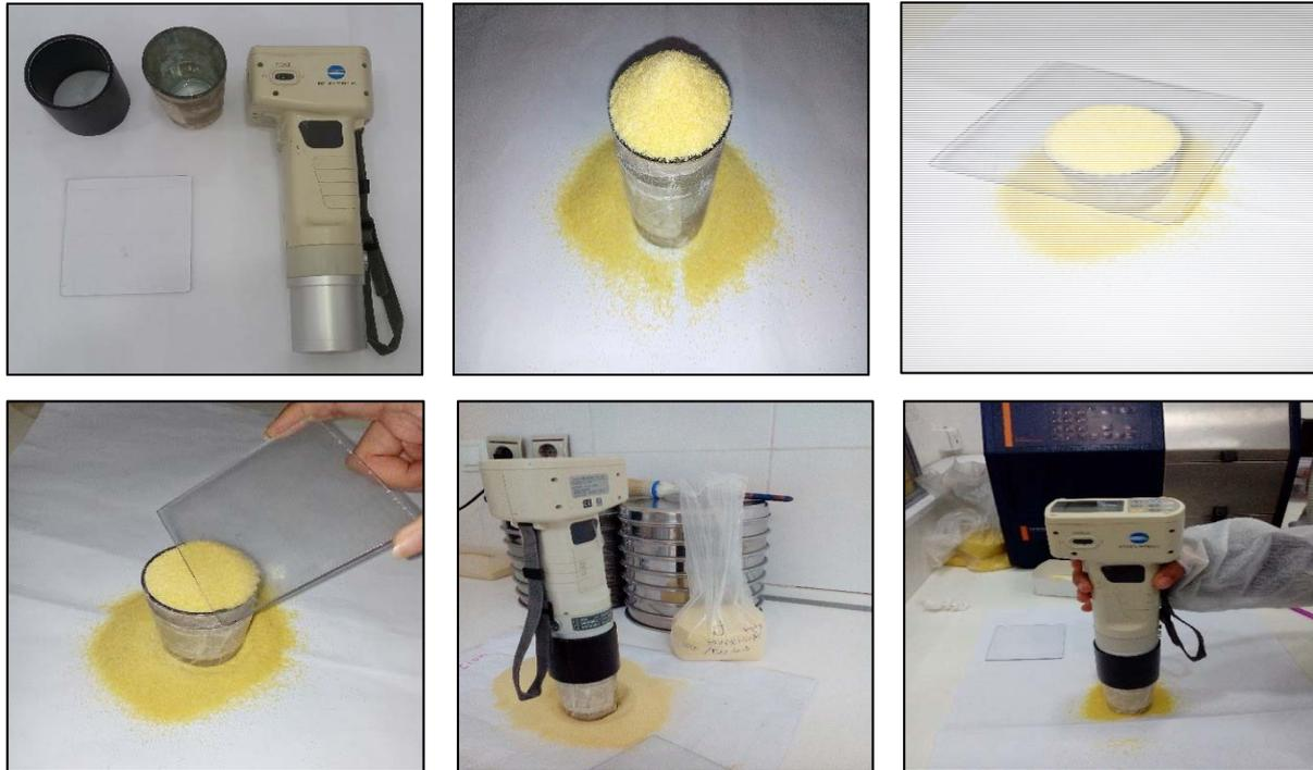
Figure 9. Analyse colorimétrique des pâtes.
