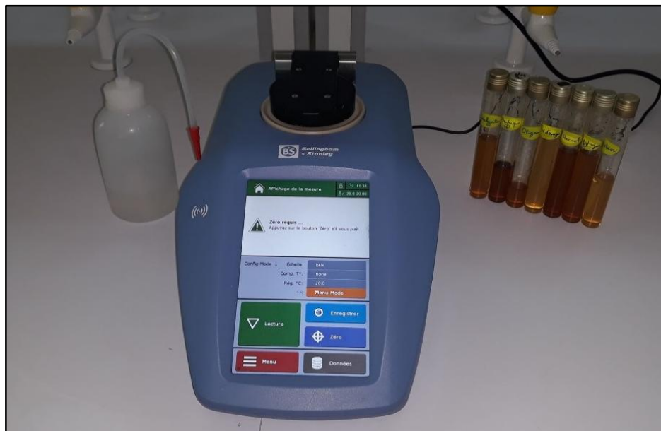
Figure 2 : Réfractomètre de type Bellingham et Stanley (photo personnelle, 2019).
