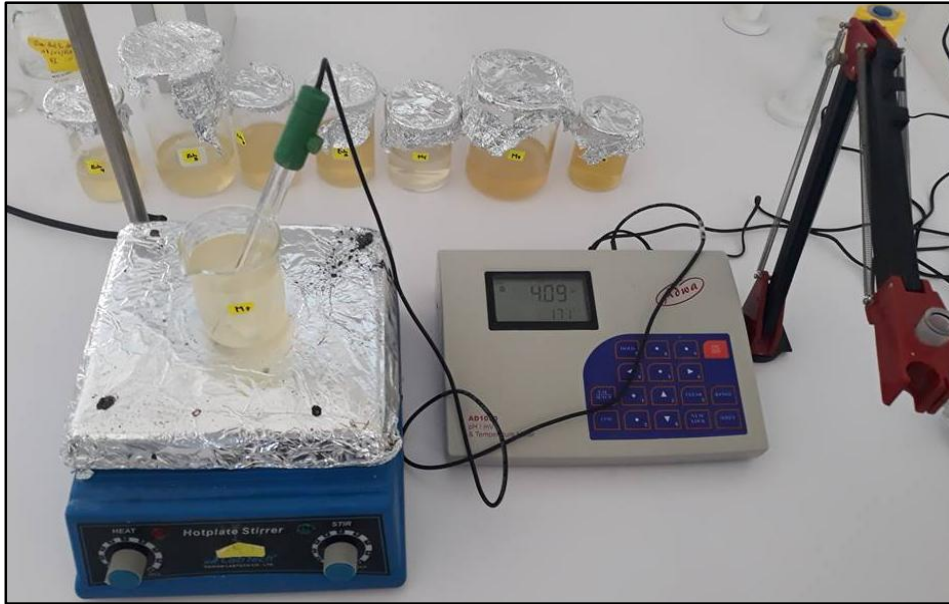
Figure 4 : PH mètre de type AD1030 (photo personnelle, 2019).
