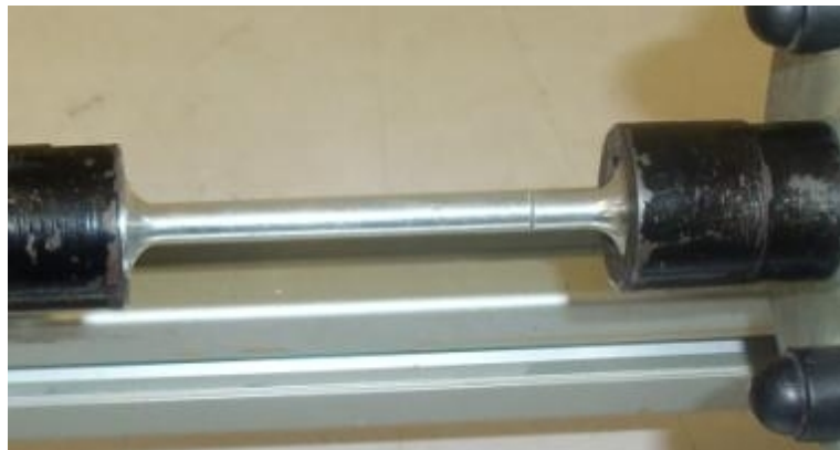
Fig. III.11 : Epreuve à la rupture
