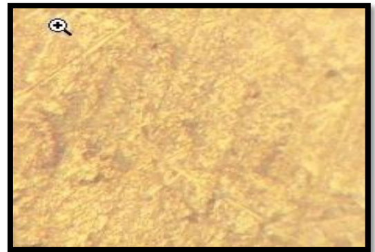
Fig. IV.16 : Epreuve recuite déformée à 66% (périphérie zoom X40)
