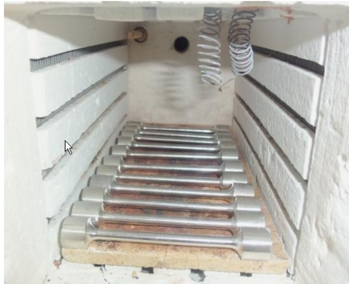
Fig. III.5 : Disposition des éprouvettes à l'intérieur du four
