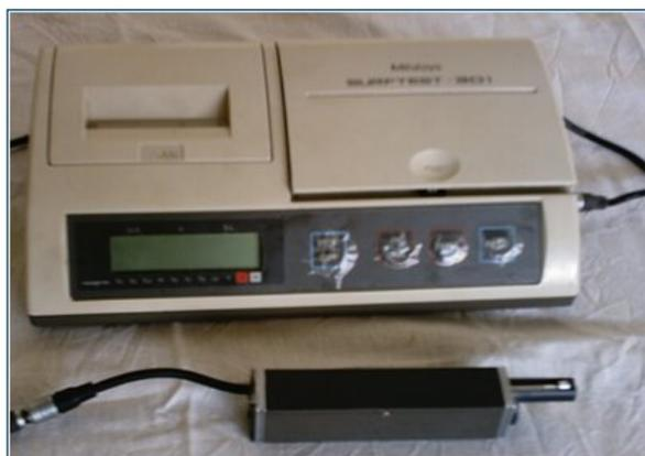
**Figure II-43.** Rugosimètre Surfets 301.
