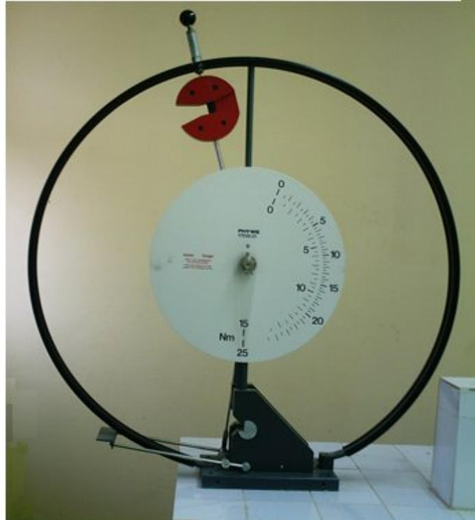
**Figure II-14.** Machine d'essai de choc Charpy
