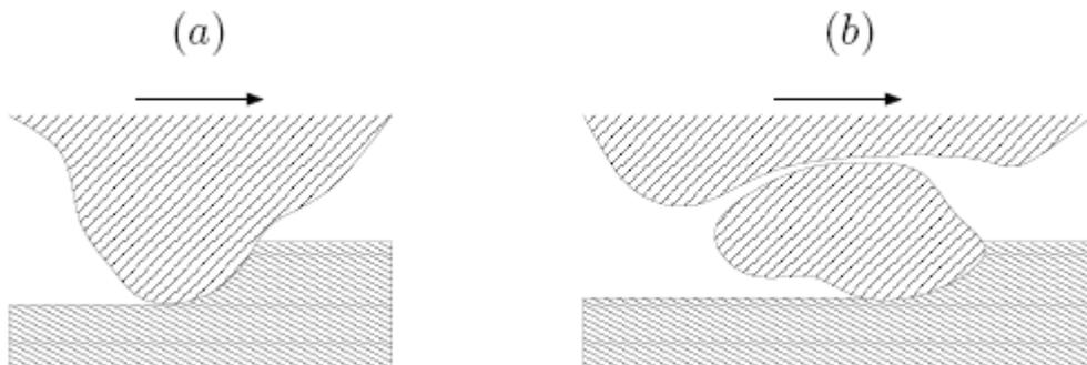
**Figure I-11.** Usure par abrasion. (a) Abrasion à deux corps
