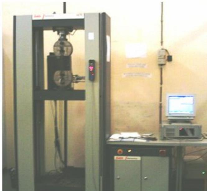
**Figure II-21.** Machine«147670 » d'essai de traction
