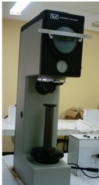
**Figure II-8** : appareil de dureté (WOLPERT)
