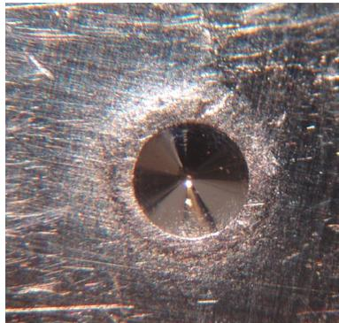
**Figure II -11.** Empreintes (cône) HRC pour 16MnCr5 cémenté (X40)
