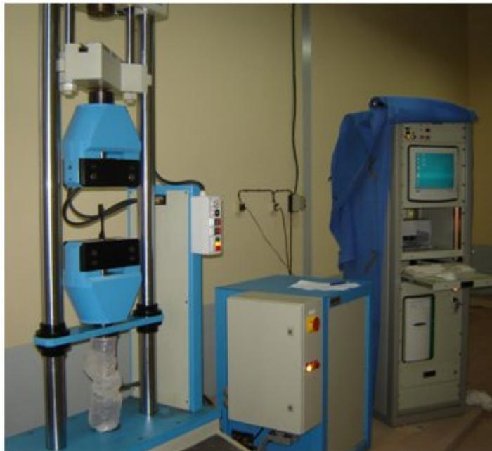
**Figure II-30.** Machine « Hoyton-S-L » d'essai Universel de traction
