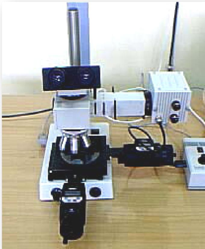
**Figure II-8** Microscope pour la mesure de l'usure.
