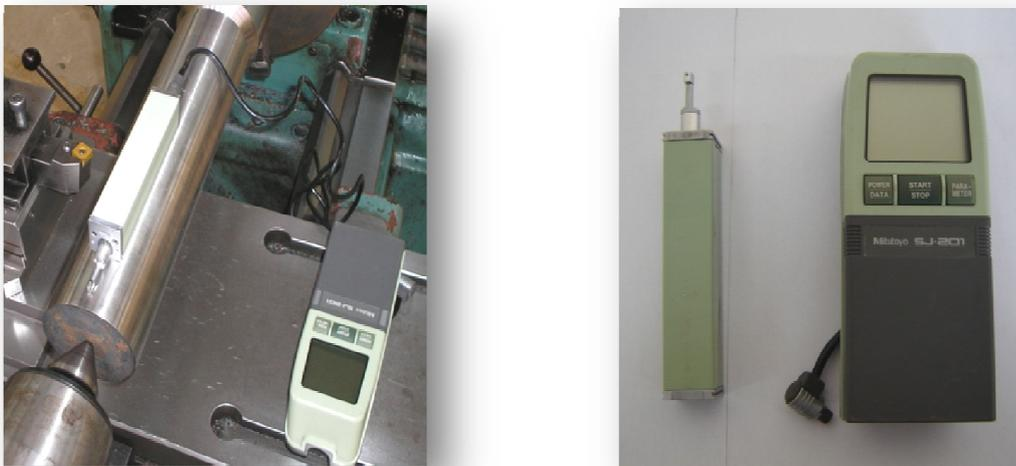
**Figure II-7** Rugosimètre SJ 201 (Mitutoyo).
