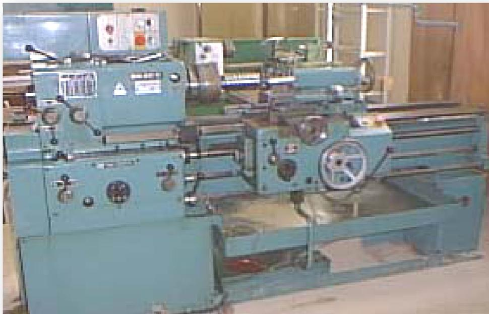
**Figure II-1** Tour parallèle modèle SN40C.
