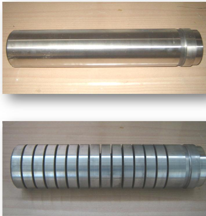
**Figure II-2** Eprouvette utilisée pour les essais.
