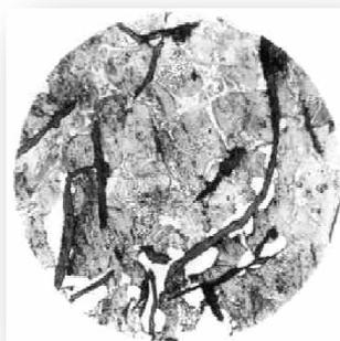
**Figure II-3** Structure de la fonte grise Ft25.
