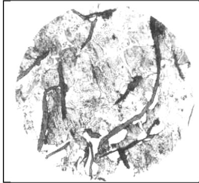
Figure I-33 Structure d'une fonte grise.
