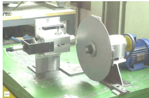
Fig. 1.2 Affûtage des disques
