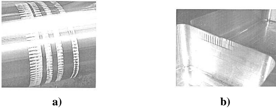
Fig. 1.8 Rugosités des pièces lors de l'apparition du broutage. (a) tournage, (b) fraisage
