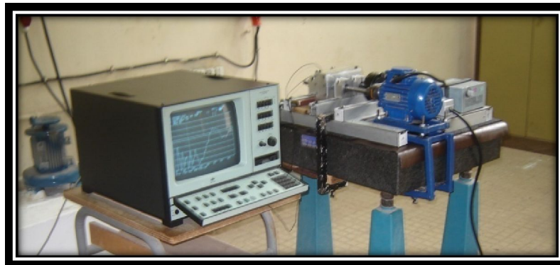
Figure 3.3 : Photo de l'analyseur de Fourier Bicanale de type B&K 2035 à gauche, et le dispositif d'expérience à droite.
