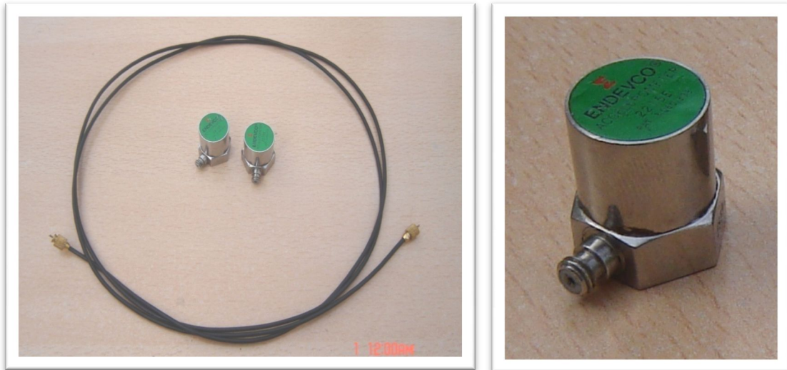
Figure 3.2 : Accéléromètres d'acquisition des signaux de type piézo-électrique « ENDEVCO Model 2215 E »
