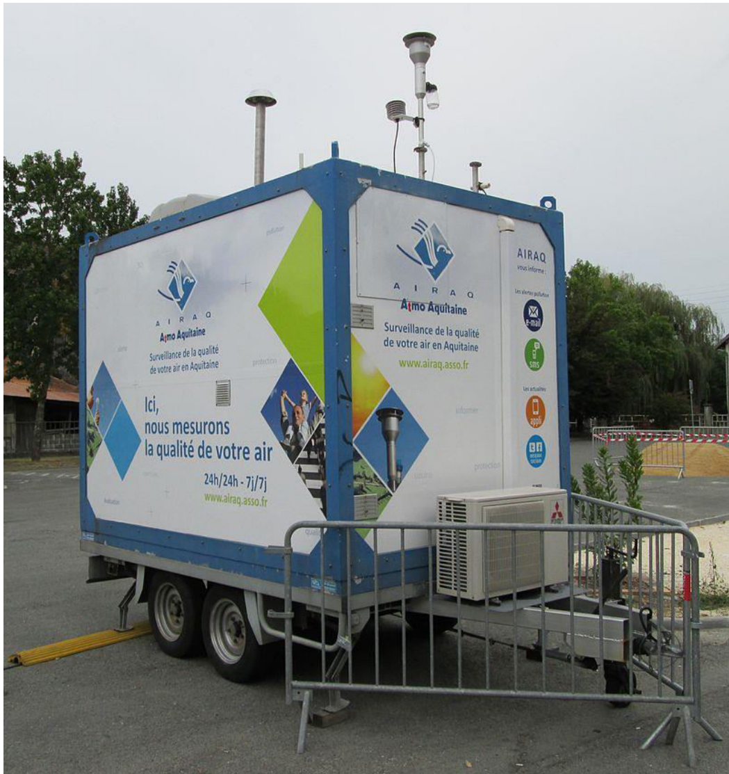
Figure 13: Remorque laboratoire située en centre urbain, en Aquitaine (Sud ouest de la France). La tête de prélèvement est visible à son sommet ; le module du climatiseur est situé devant la remorque.
